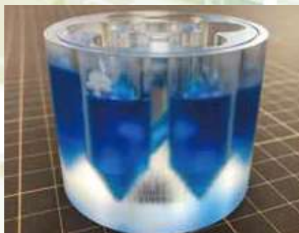
【第2槽-第3槽】・流路: 穴 ・液面高低差: なし ・効果: 短絡防止
