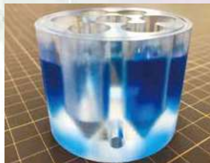
【第6槽-第1槽】・流路: なし ・第6槽に流れ込む 反応液を抜き出す
