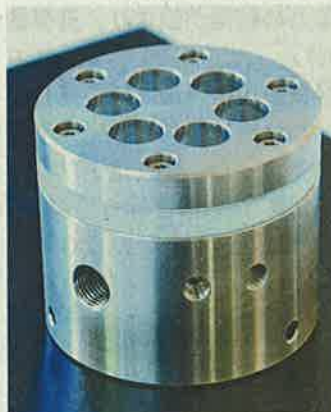
密封タイプの小型プラント。上ぶたの六つのガラス窓から槽の中の様子を確かめることができる。
